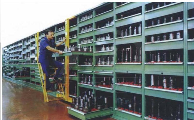
左图：2排刀具架靠墙布置，存放常用刀柄；
