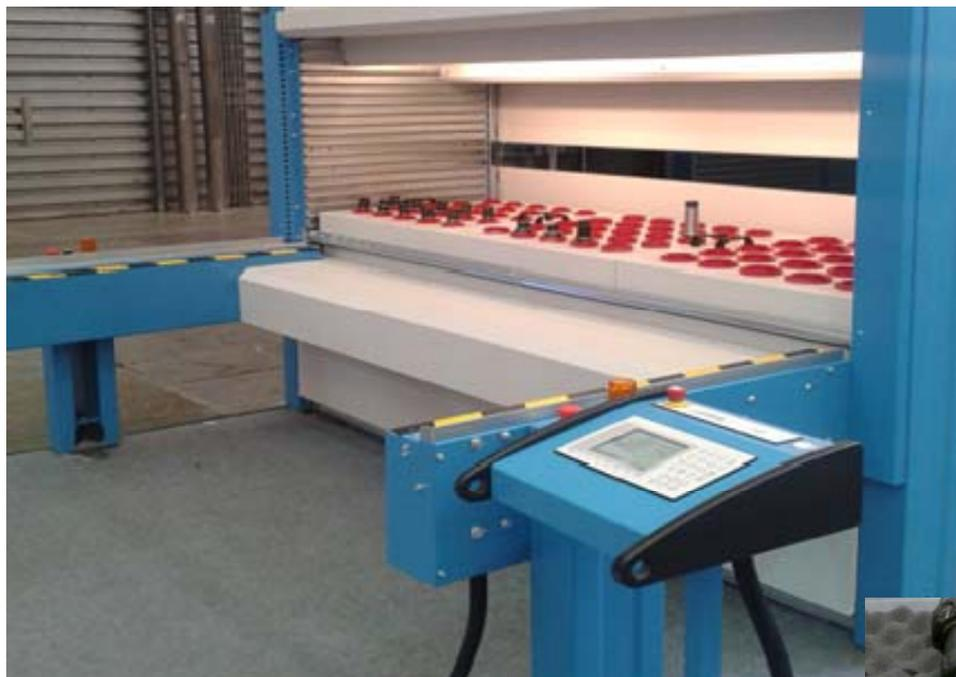
自动货柜托盘配置保护棉存储刀具案例
