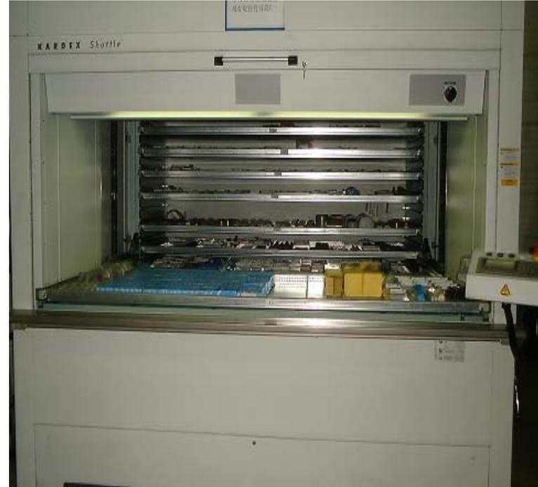
自动货柜通过分隔板存储刀具案例
