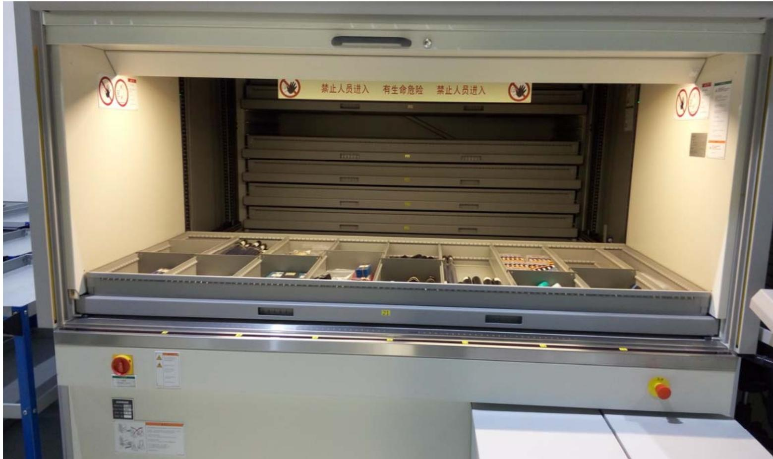
自动货柜通过分隔板存储刀具案例
