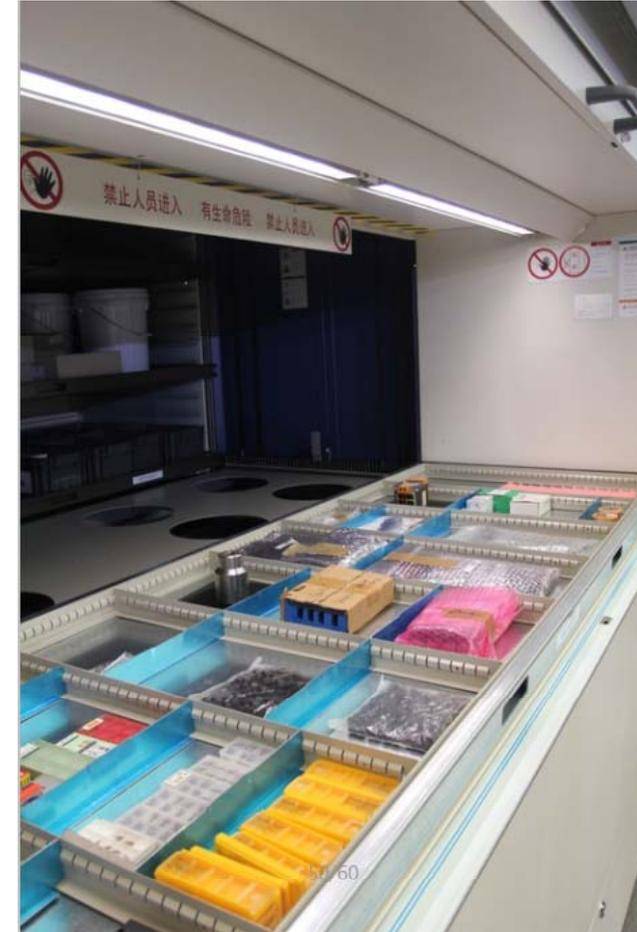
自动货柜通过分隔板存储刀具案例
